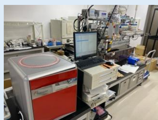
高温燃焼による C, N, S元素の検出
