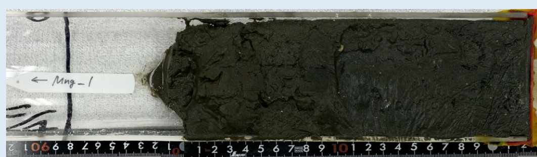
図 堆積物コア断面 (Mng_1) 有機元素測定中
